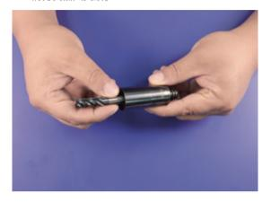
**2** Adjust knife length. 調整夾頭長度。
